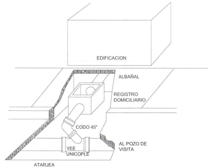
DETALLE DE CONEXIÓN DE ALBAÑAL
