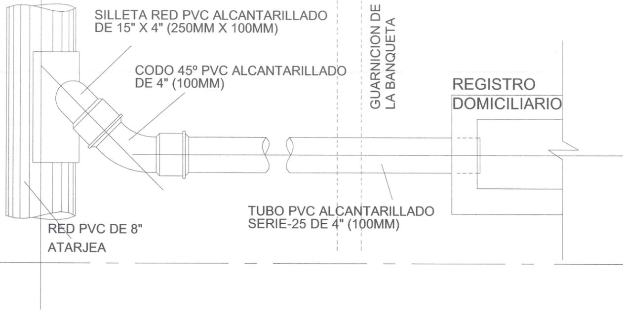
SILLETA RED PVC ALCANTARILLADO DE 15" X 4" (250MM X 100MM)
